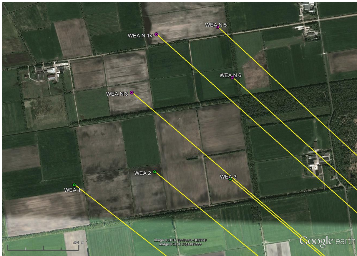
Abbildung 11: Gesamtübersicht des Windparks Dietrichsfeld der geplanten Windenergieanlagen (grün) sowie der benachbarten Windenergieanlagen Neuschoo-Südmoor. Die Einstrahlungsrichtungen bzgl. der Radaranlage Brockzetel sind gelb dargestellt.
